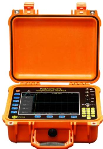
РИ-407 – высокоточный цифровой рефлектометр, специально разработанный для определения расстояний до любых типов неоднородностей и повреждений **в силовых кабельных линиях**: обрыв, короткое замыкание, муфта, сростка кабеля, параллельный отвод, замокание кабеля, высокоомные повреждения, заплывающий пробой и пр.
